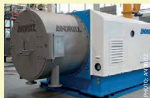
Andritz pusher centrifuge.
