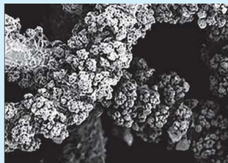
a) SEM image of a top gauze layer
