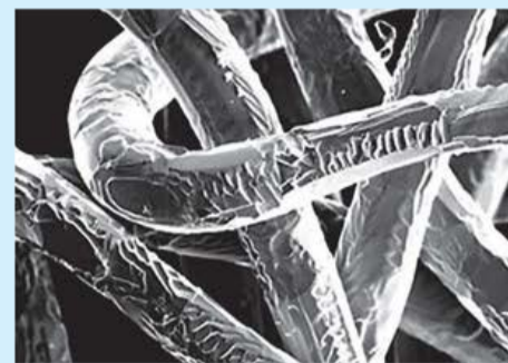
c) SEM image of a bottom gauze layer
